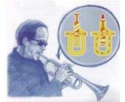
Pour un instrument à vent, on  $f = \frac{v}{2L}$  avec f fréquence fondamentale L
