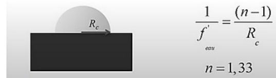
Figure 2 Schéma et photographie de la goutte d'eau.
