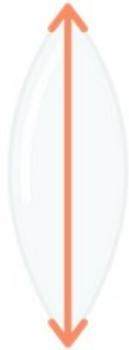
Une lentille convergente est symbolisée par 2 flèches orientées vers l'extérieur.
