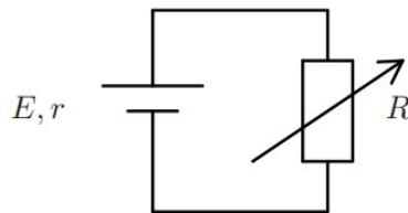
La puissance dissipée dans le résistor est donnée par la formule  $P = \frac{E^2 R}{(R + r)^2}$ .
