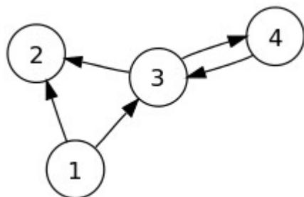
Un graphe est une représentation composée de sommets (points) et d'arêtes (segments)
