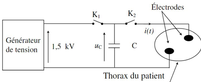
La capacité du condensateur  $C$  est de  $470 \mu\text{F}$ .
