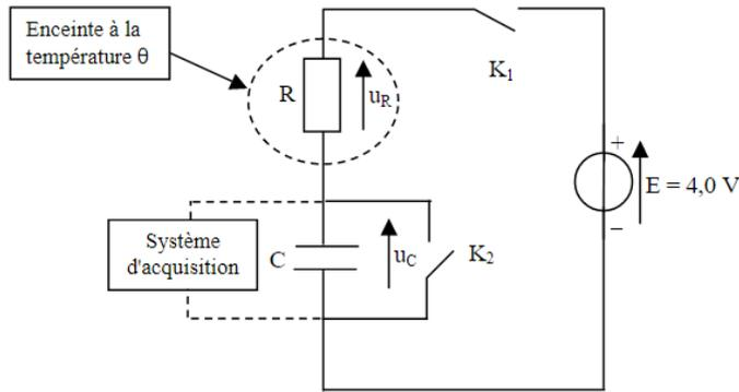
Le condensateur a une capacité  $C = 1,0 \mu\text{F}$
