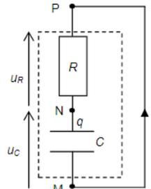
Figure 2. Circuit de décharge
