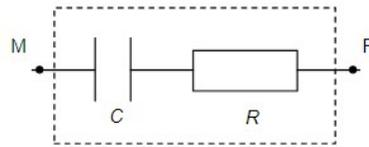
Figure 1. Modèle du supercondensateur
