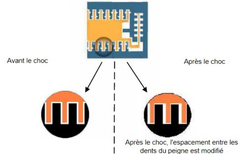
Figure 3 : Fonctionnement de l'accéléromètre et déclenchement d'airbag
