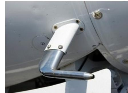
Cette sonde cylindrique baigne dans un écoulement d'air stationnaire. L'air est considéré comme étant un fluide parfait, de masse volumique  $\rho_0$  uniforme et de vitesse  $\vec{v}$  parallèle à l'axe de la sonde.
