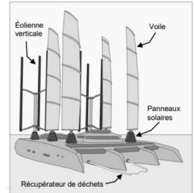
Des panneaux solaires et des éoliennes permettront de fournir l'énergie nécessaire au Manta.
